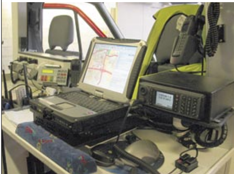
Johtokeskusauton viestivälineistöä. Tietokoneen ruudulle saadaan tarkkaa paikkatietoa ja muuta palokunnan toimintaa helpottavaa informaatiota.
