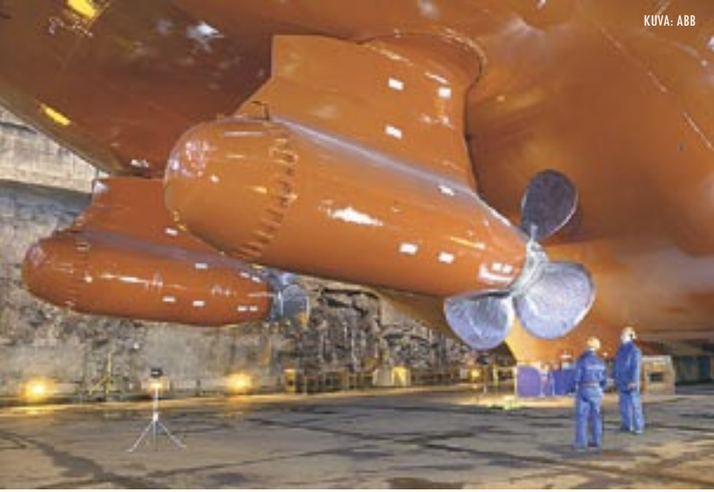
Valmis Azipod jäänmurtajaan asennettuna.
